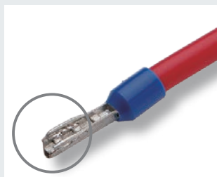
棒状端子破损
