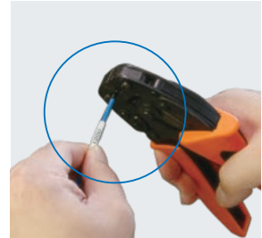
压接处理（填缝）
